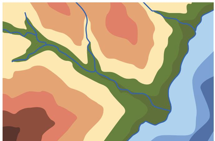
▲ Rappresentazione del rilievo e della profondità con il metodo delle tinte isometriche
